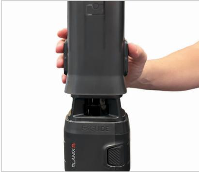
Retirez la protection système en appuyant sur les languettes de déverrouillage et en tirant la protection système vers le haut tout en maintenant fermement la base du PLANIX R1.
